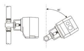
На горизонтальный трубопровод электропривод необходимо ставить под углом в промежутке от 0° до 60° относительно вертикальной оси. Причем чем выше температура регулируемой среды (более 80 °C) угол должен быть больше (макс. 60°) во избежание перегрева привода.
