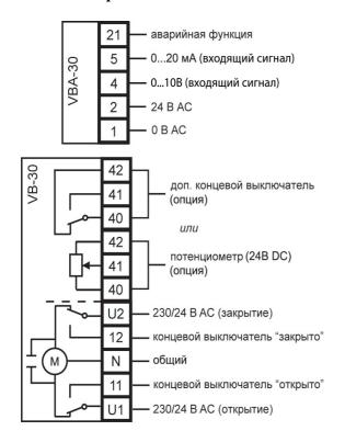
Снимите верхнюю крышку, открутив два винта. Соединение проводится через клеммный разъем согласно Кабель электрическим схемам. быть управляющего сигнала должен экранированным. Сечение проводов питания не менее 0,5 мм и не более 1 MM.
