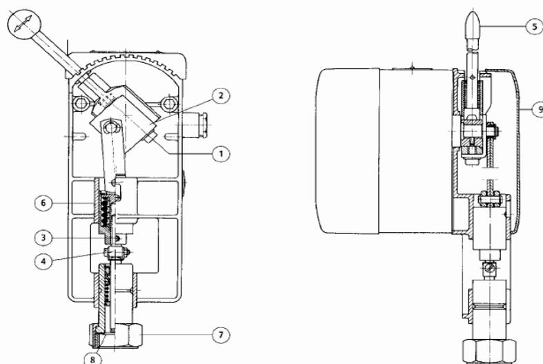
1. На горизонтальный трубопровод электропривод необходимо ставить под углом в промежутке от 0° до 60° относительно вертикальной оси. Причем чем выше температура регулируемой среды (более 80 °С) угол должен быть больше (макс. 60°) во избежание перегрева привода (см. «Установка на системе»).
