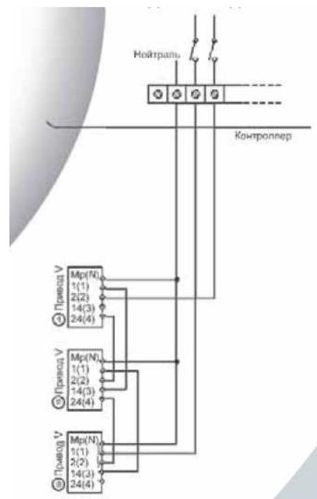
Каскадное подключение электроприводов обеспечивает последовательное управление двух и более электроприводов с помощью одного сигнала от контроллера.
